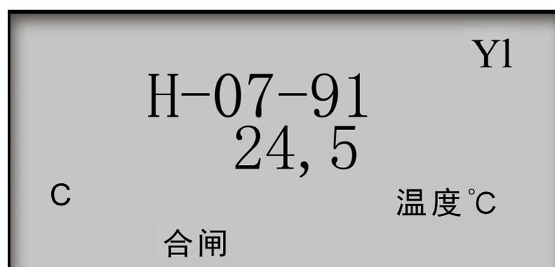
1.11 第一行显示当前时/分/秒(联网才有效)，第二行显示当前零线温度
